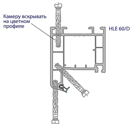
3.11.5 Выполнение отверстий отвода воды на створке.
