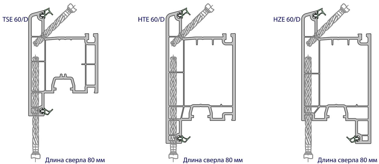
3.11.7 Выполнение отверстий отвода воды на импосте.
